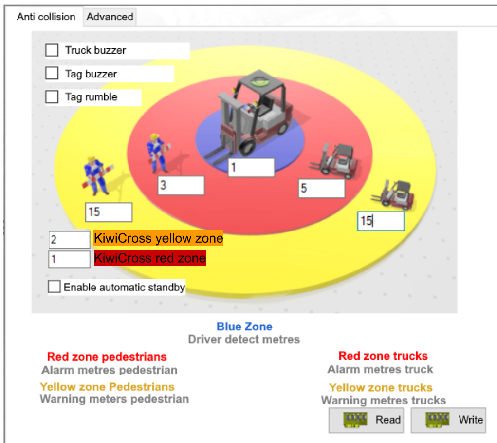
Rys. 24 – KiwiCross UWB – Ekran antykolizyjny
