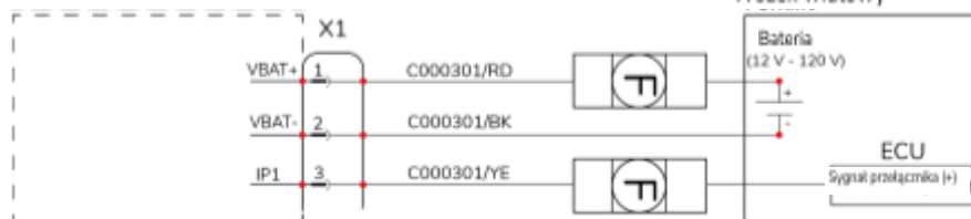
Rys. 34 - Podłączenie zasilania wózków elektrycznych
