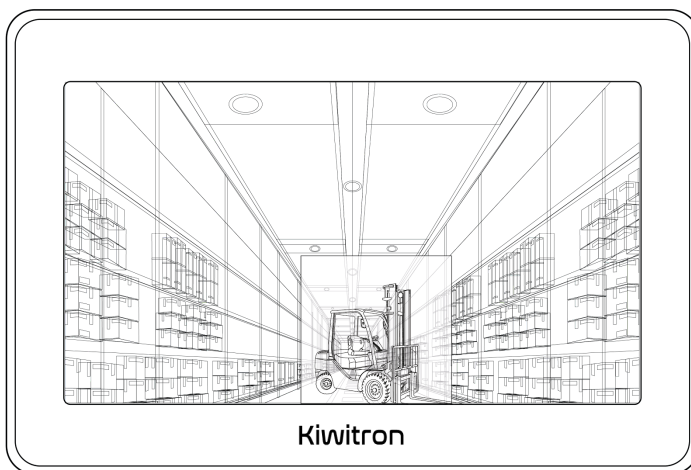
Rys. 24 – Wyświetlanie tylko tylnego KiwiEye, włączony bieg wsteczny
