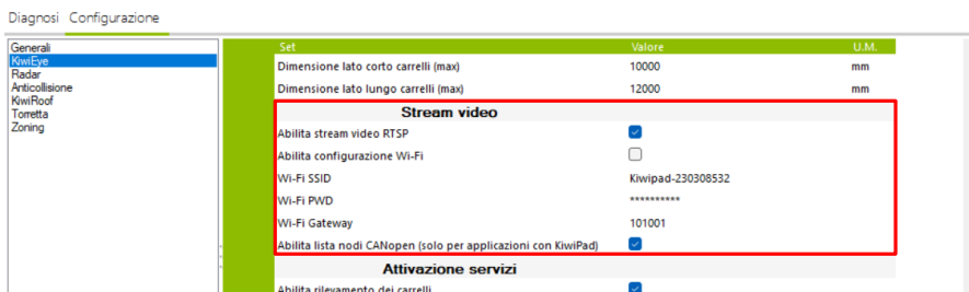
Fig.24 - Verifica servizio streaming RTSP KiwiEye con KiwiSafe
