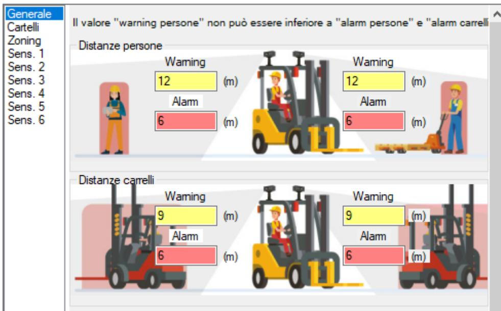
Fig.36 - KiwiEye - Configurazione distanze
