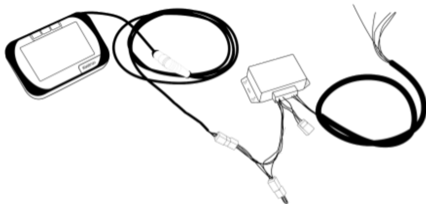
Fig.33 - Collegamenti minimi (esempio con KeyTouch)
