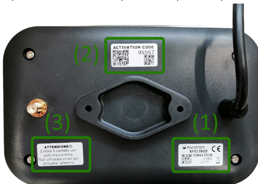
Fig.6 - Ejemplo de aplicación de etiquetas en el dispositivo KeyTouch
