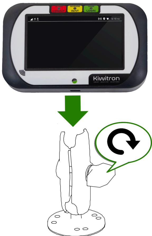
Fig.17 - Fijación de perno en soporte
