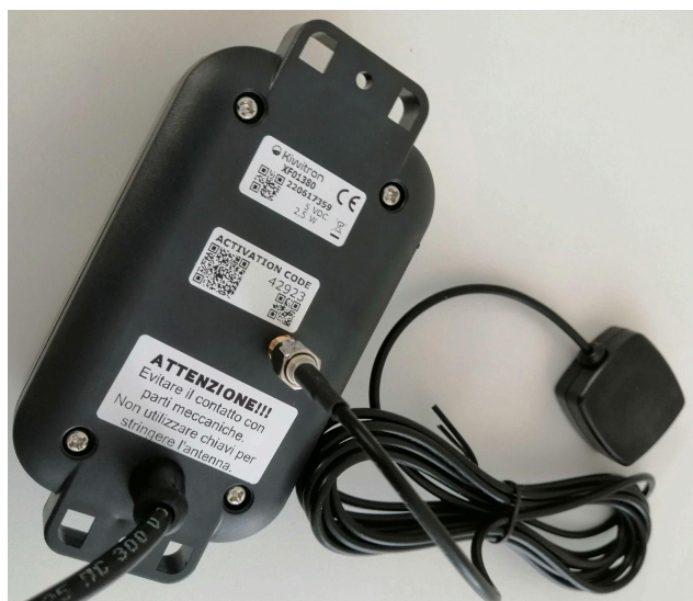
Fig.11 - Conexión de antena GPS
