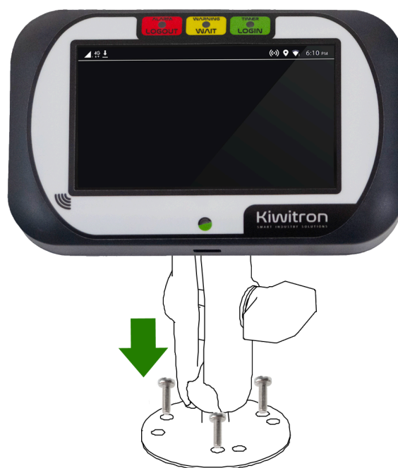
Fig.18 - Fijación lado vehículo
