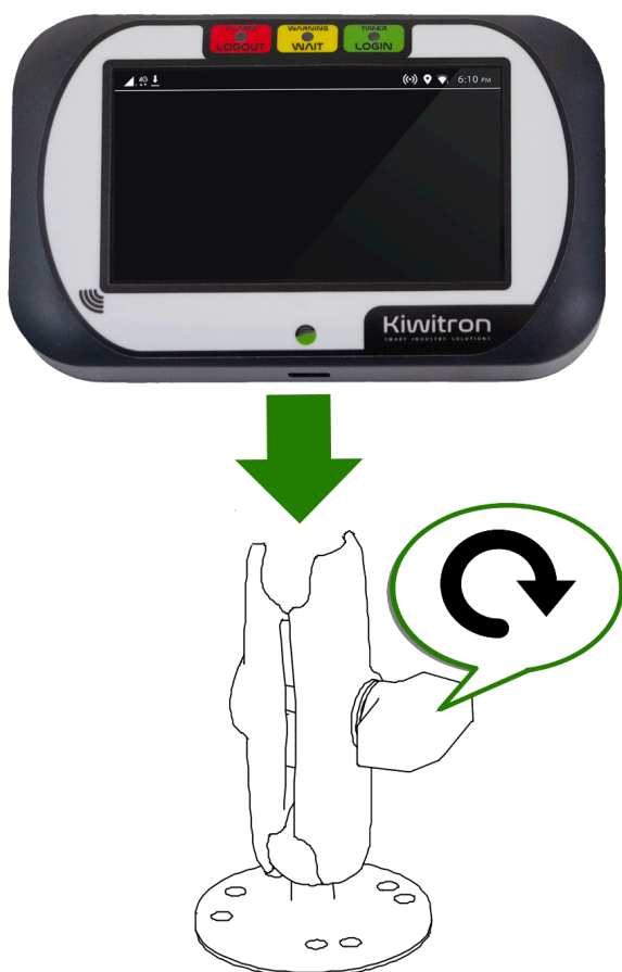
Abb.17 - Stiftbefestigung am Rahmen
