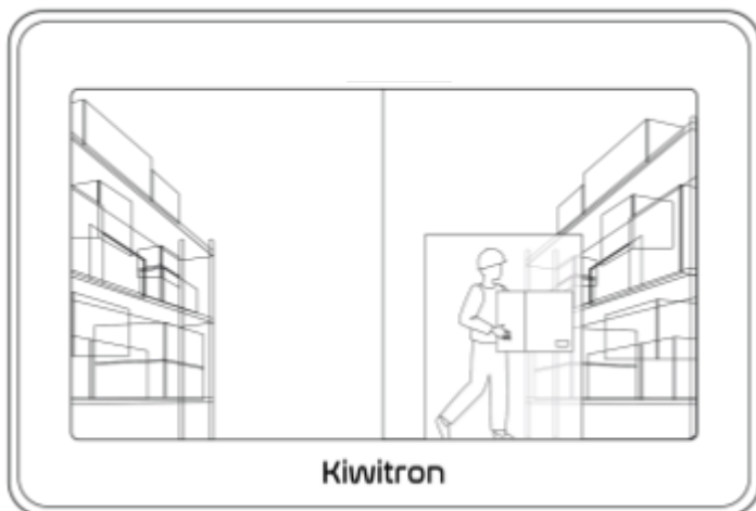
Fig.23 - Visualizzazione dei soli KiwiEye anteriori, marcia avanti inserita
