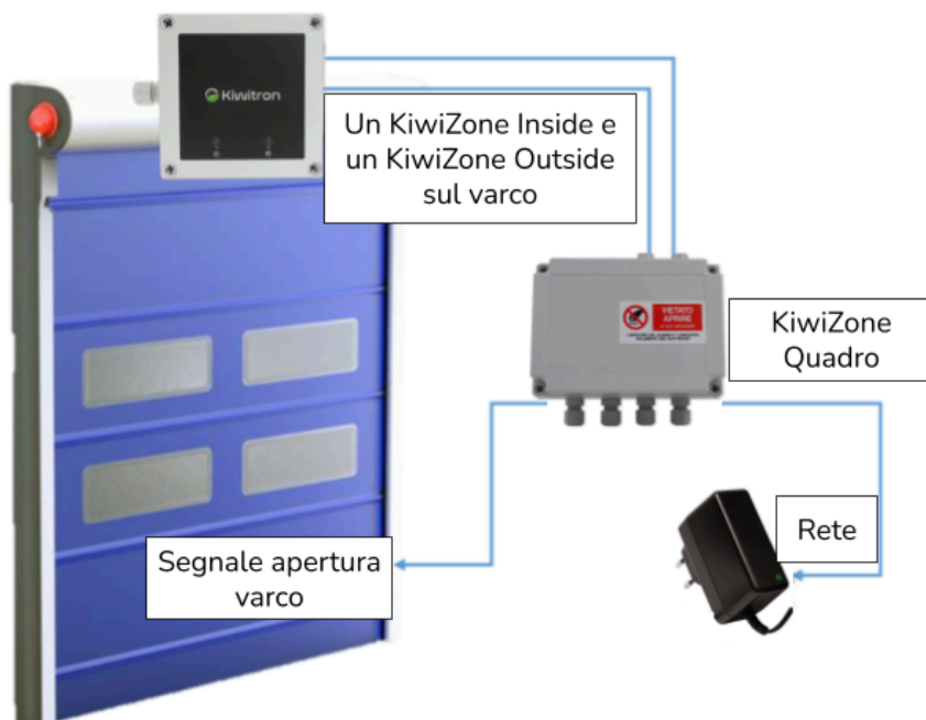
Fig.17 - Esempio schema collegamento KiwiZone - Gate
