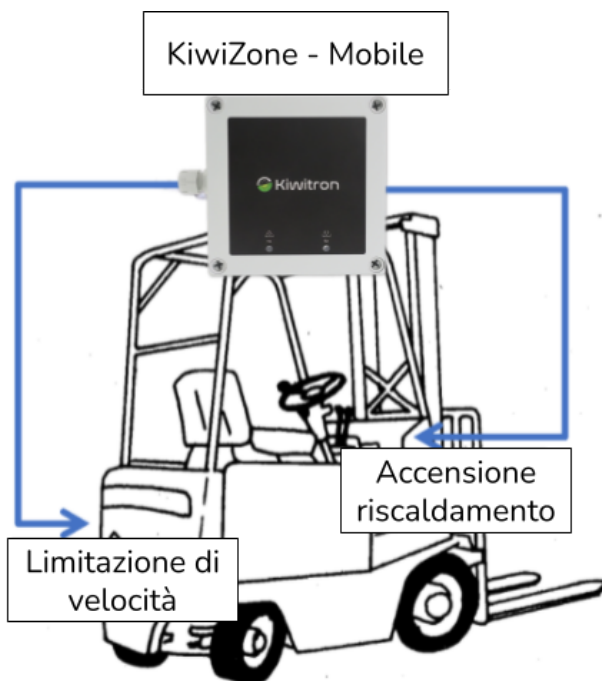
Fig.17 - Esempio schema collegamento KiwiZone - Mobile
