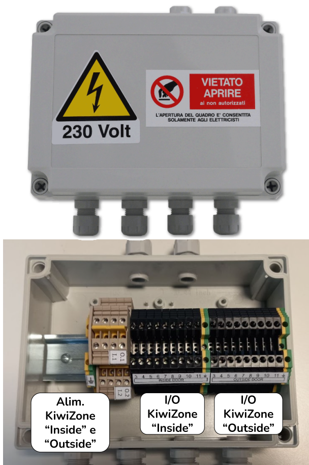
Fig.4 - Panoramica KiwiZone - Gate Quadro (M200500)
