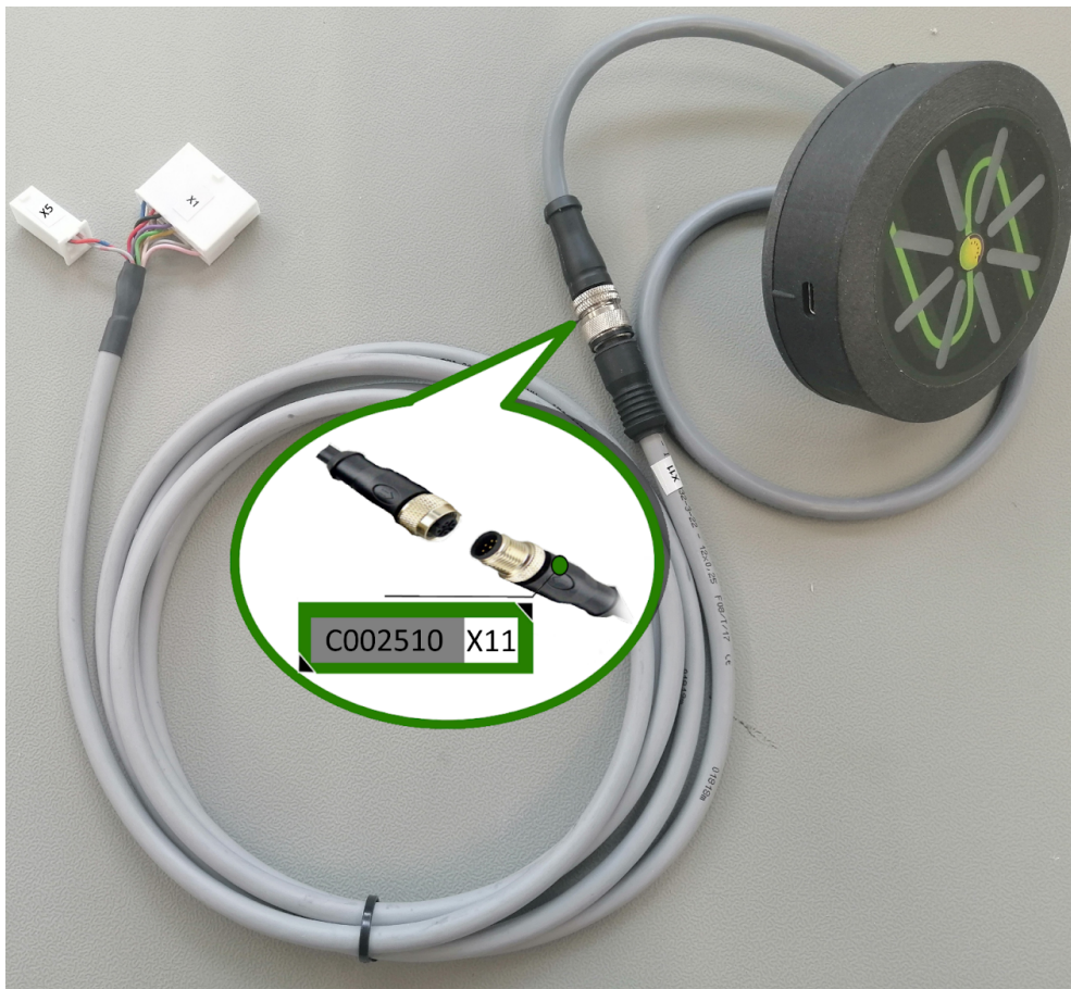
Fig.12 - Conexión del cable C002510 - X11
