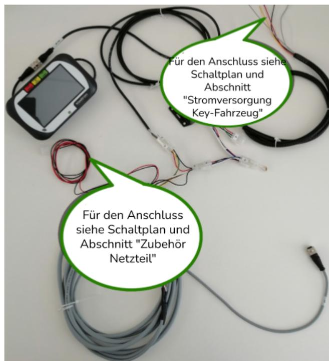
Abb.43 - Key + Zubehörkabel - Stromversorgung
