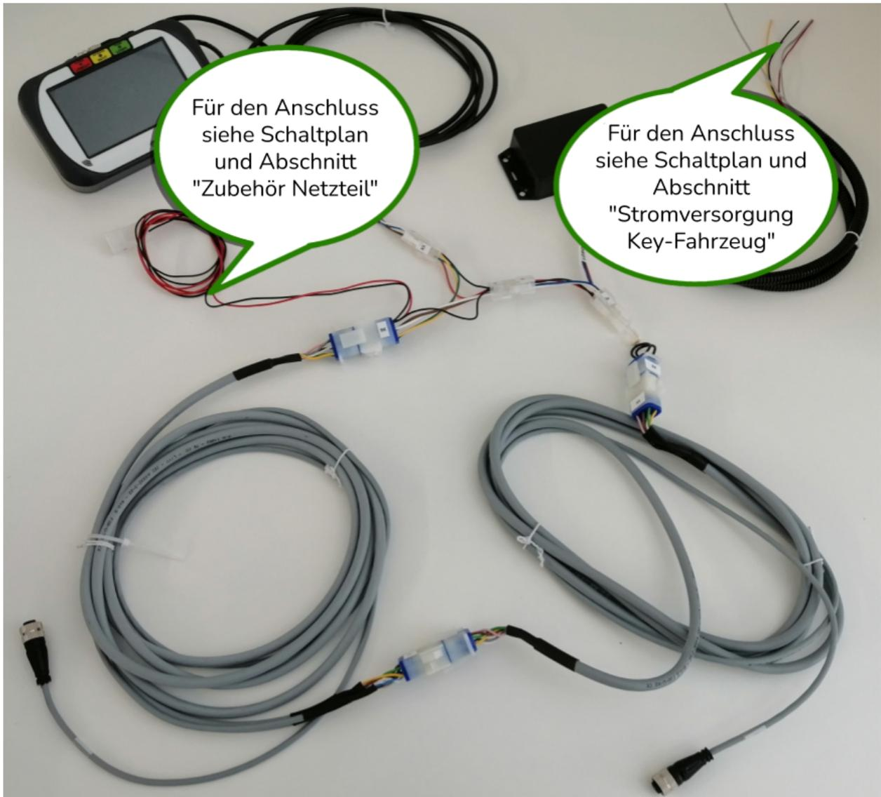
Abb.58 - Anschluss der Zubehörstromversorgung in Kaskade an X6
