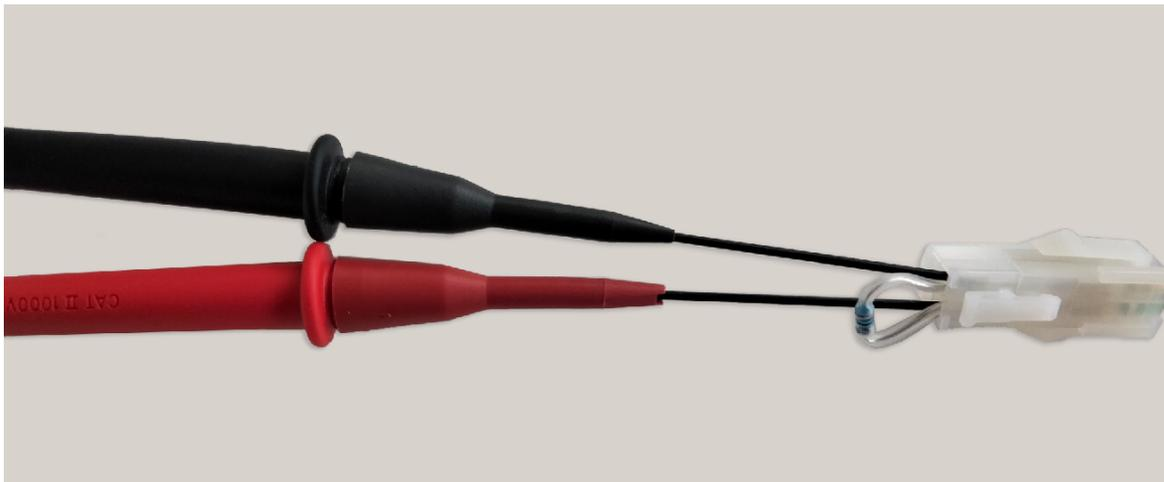
Abb.8 - Multimetertest auf der CAN-BUS-Leitung
