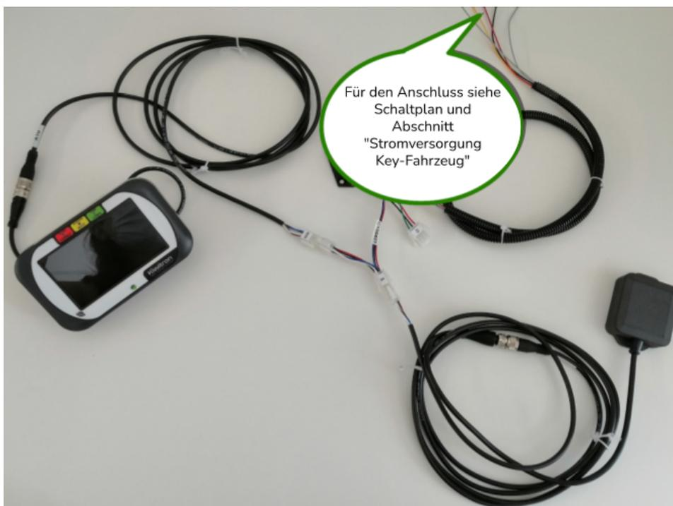
Abb.32 - Key + KiwiCall Wagen - Spannungsversorgung
