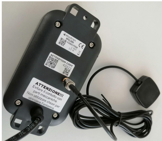
Abb.11 - Anschluss der Satellitenantenne
