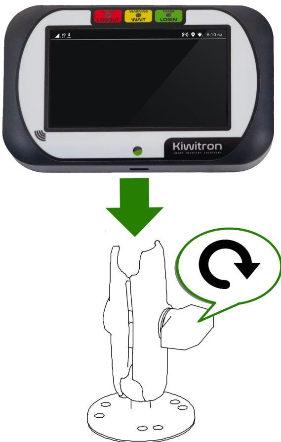
Abb.17 - Stiftbefestigung am Rahmen
