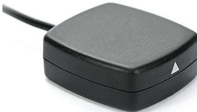
Abb.10 - Installationspfeil der GPS-Antenne
