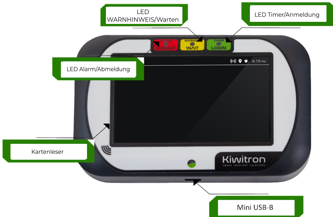
Abb.3 - Übersicht KeyUP - KeyTouch (Frontseite)
