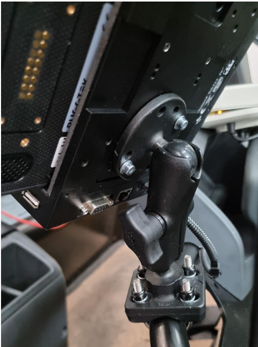
Abb.17 - Beispielhafte Tabletinstallation mit RAM-Rahmen
