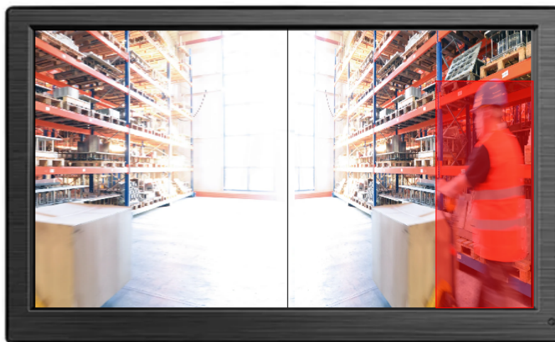
Abb.20 - KiwiEye-Anzeige vorne, nur Key, eingelegter Vorwärtsgang
