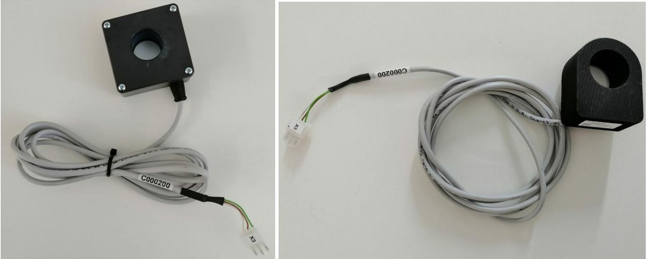
Fig.16 - Sensores de corriente (X200601 y X000701)
