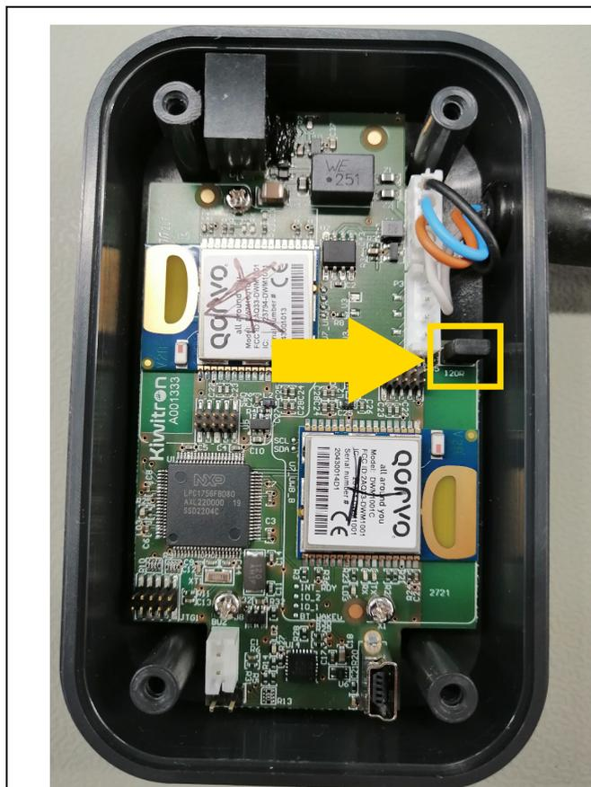
Fig.60 - Anticolisión con resistencia de equilibrado activa
