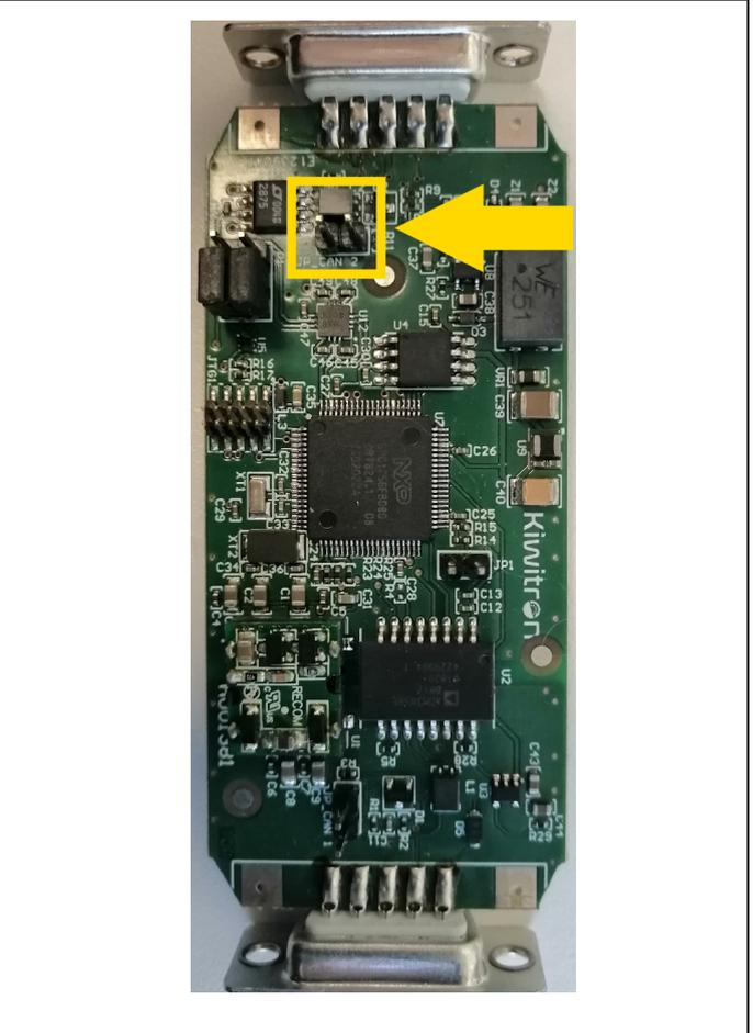
Fig.63 - CANGateway con resistencia de equilibrado desactivada
