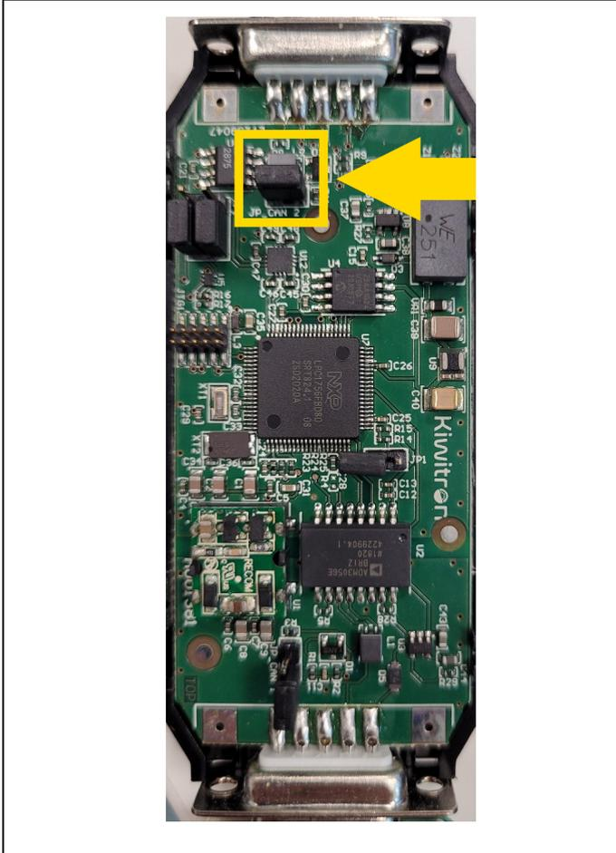
Fig.62- CANGateway con resistencia de equilibrado activa
