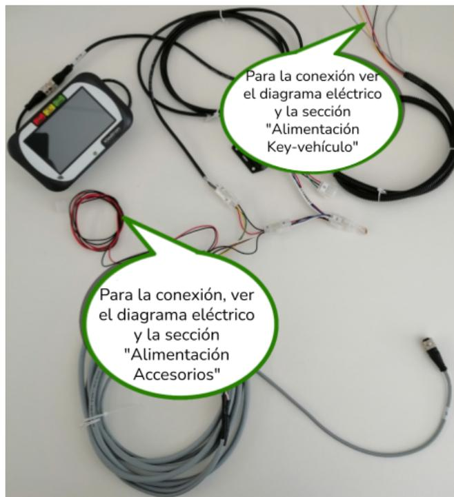
Fig.43 - Key + Cable accesorios - Alimentación
