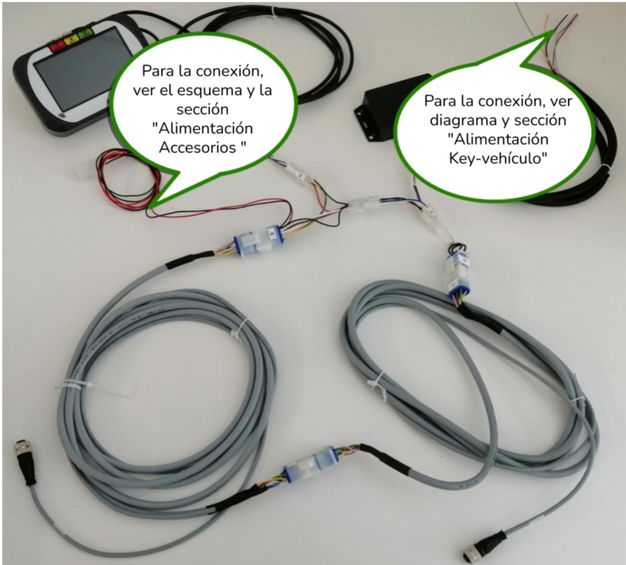
Fig.58 - Conexión de alimentación de accesorios en cascada en X6
