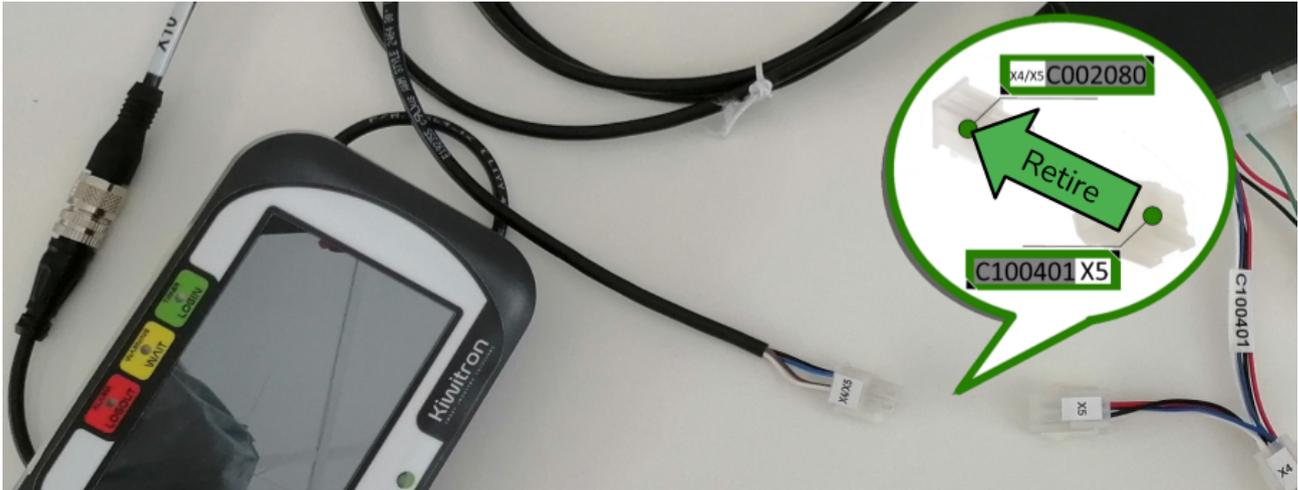
Fig.38 - Desconexión C002080 - X4/X5
