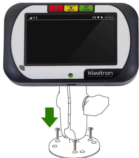
Fig.18 - Fijación lado vehículo
