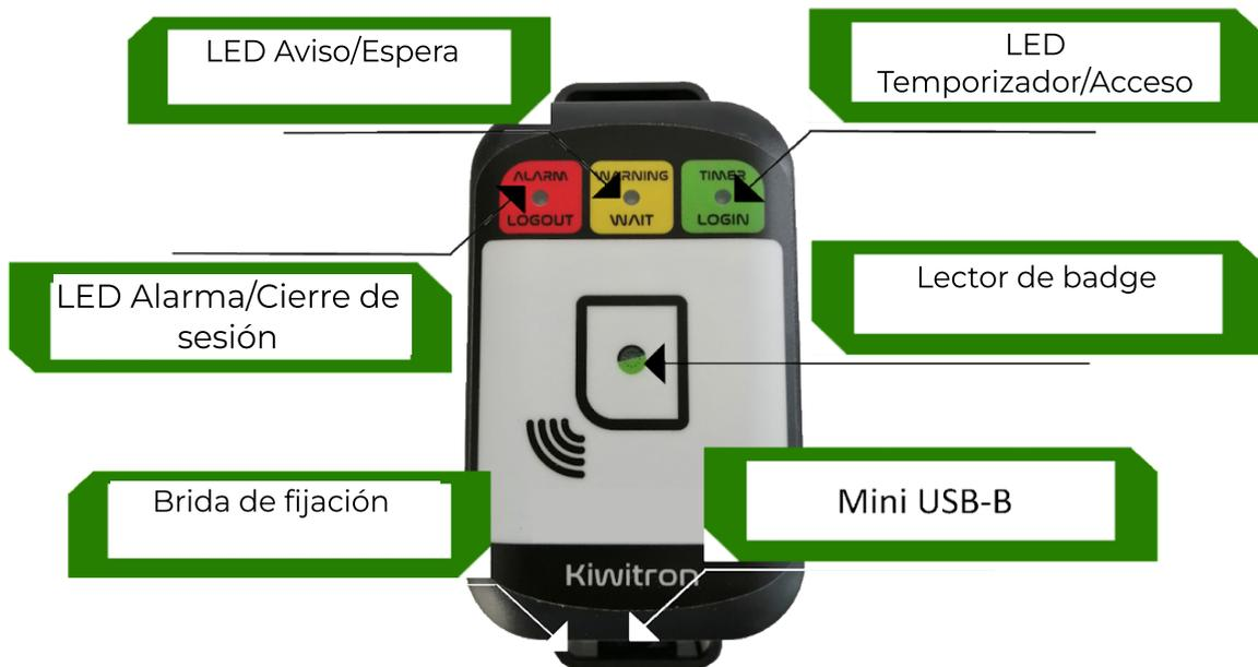
Fig.1 - Panorámica del dispositivo KeyUP - KeyAdvanced (delante)
