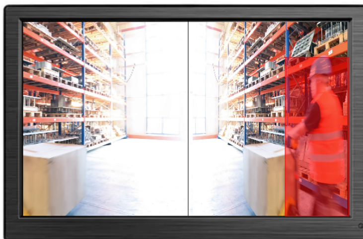
Fig.20 - Affichage des KiwiEye avant uniquement avec système Key, marche avant enclenchée
