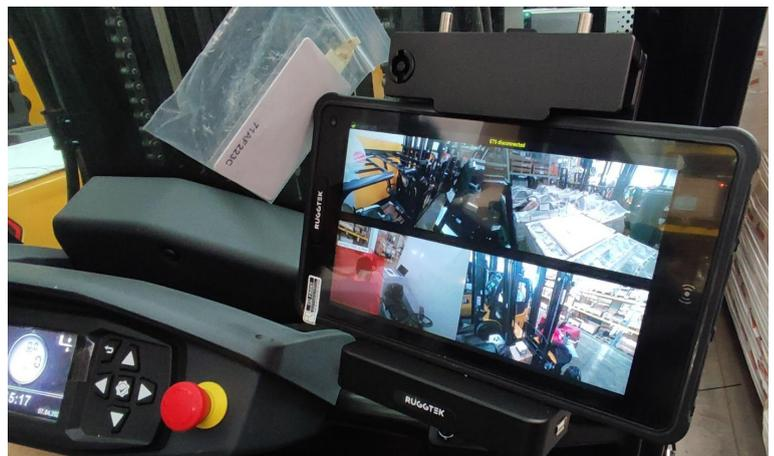
Fig.17 - Ejemplo de instalación de tablet con soporte RAM
